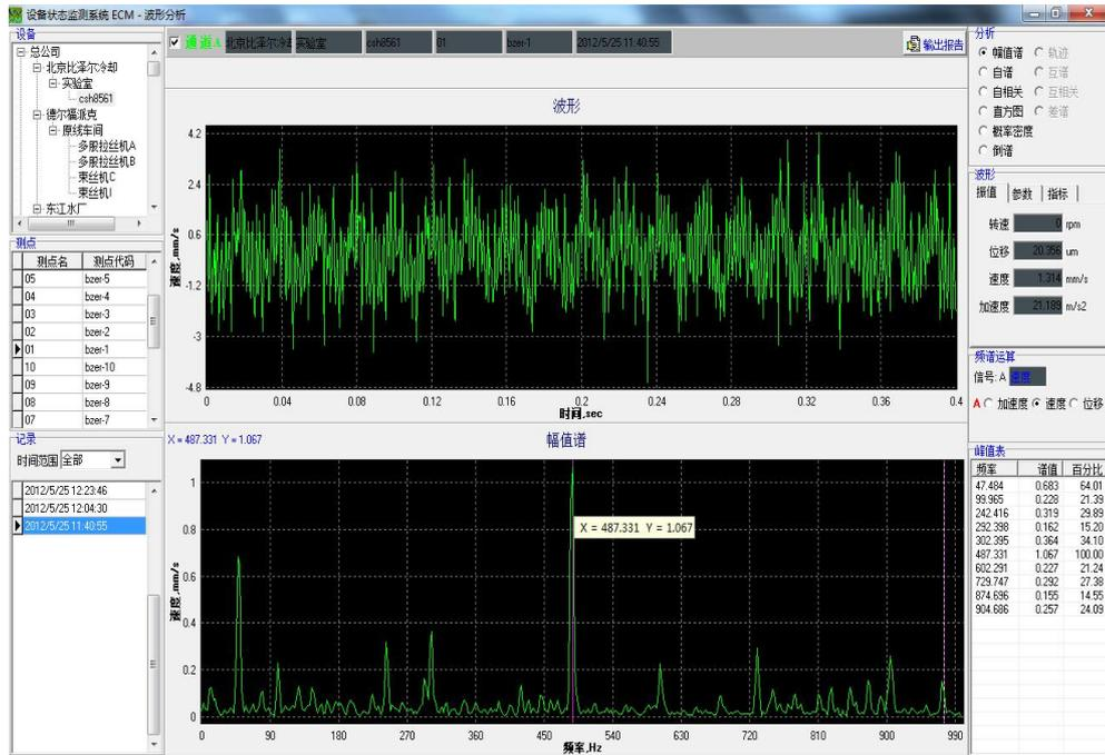
测点 1 频程 1000 波形信号速度。主要频率是  $485 \pm 5$ 、 $47.484 \pm 5$  赫兹 其中后者为电机转速频率
