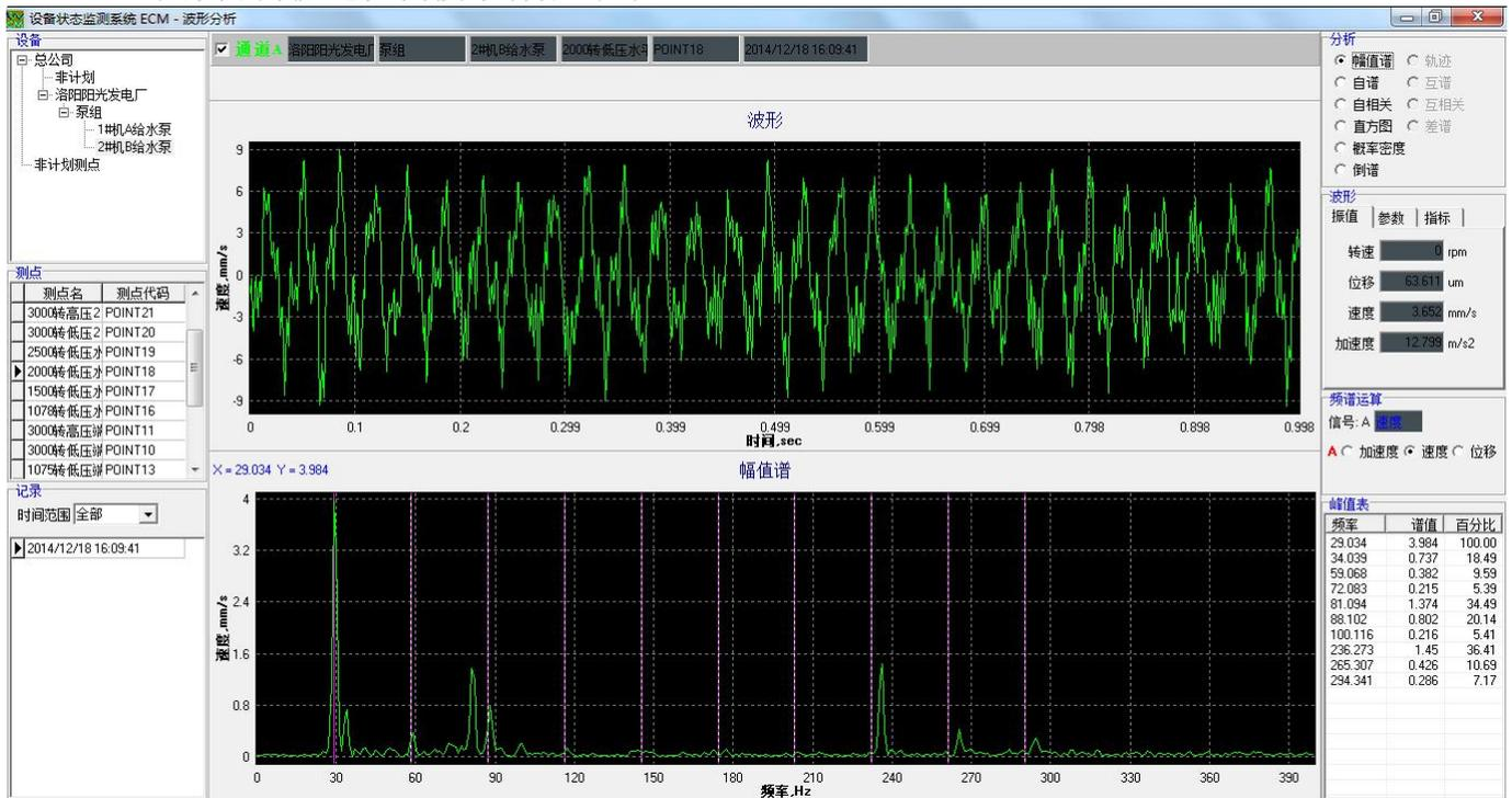
图九 2000rpm 时候振动主要体现在 29Hz 和 81Hz 以及通过频率 236Hz 振动。
